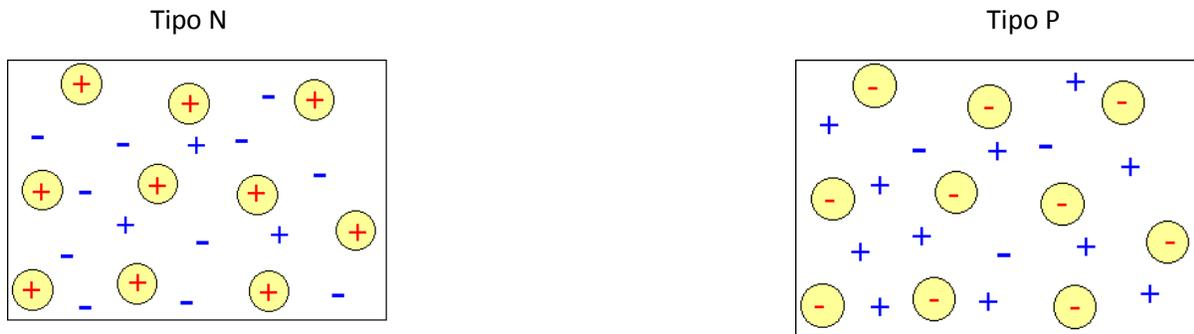
El diodo semiconductor se forma al juntar un material tipo N y un material tipo P construidos de la misma base (Germanio o Silicio).
