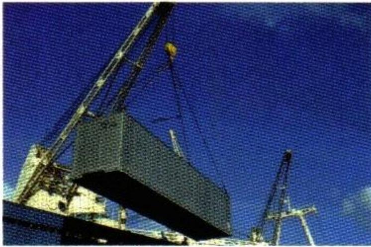
**Fotografía 2.3** Como la tensión presente en los *cuatro* cables que sostienen al contenedor de carga no se puede encontrar mediante las *tres* ecuaciones (2.34), es posible obtener una relación entre las tensiones considerando el equilibrio del gancho.
