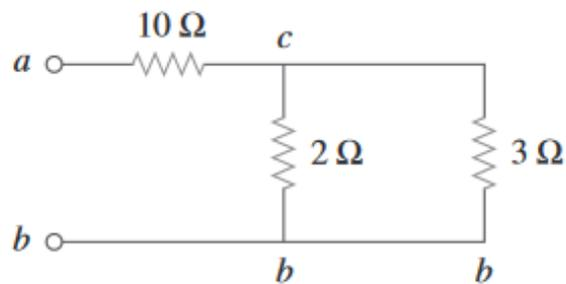
Figura 2.10: Resistencia equivalente del circuito mostrado.
