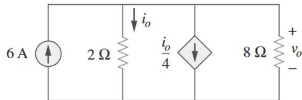
Figura 2.4: Cálculo de los valores de  $V_0$  e  $i_0$  en el circuito mostrado.
