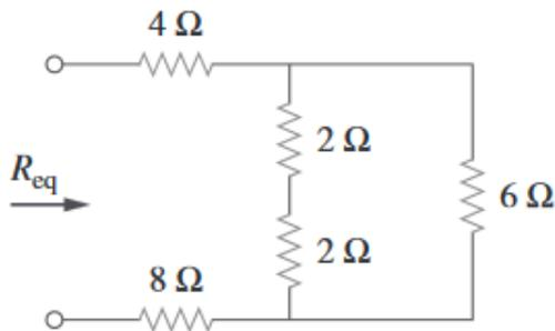
Figura 2.6: Resistencia equivalente.
