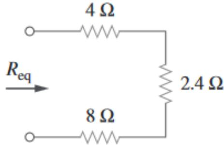
Figura 2.7: Resistencia equivalente.
