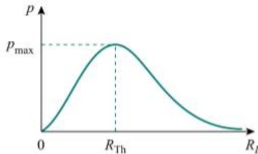
Figura 4.4: Gráfica de potencia entregada en función del valor de  $R_L$ .
