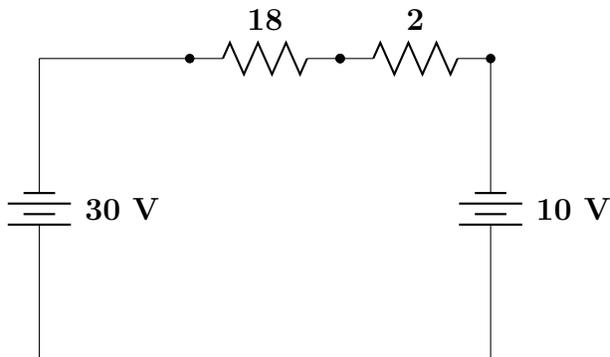
Entonces sumando la resistencia equivalente en serie y una simple resta de voltaje
