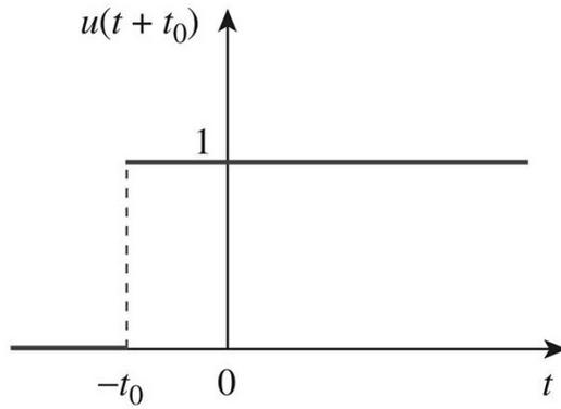
Figura 6.17: Función escalón adelantada en  $t_0$ .
