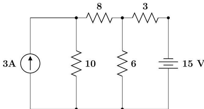
Entonces, aplicando la transformación en la fuente de corriente  $I=3A$  y nuestra resistencia con valor de 10 ohms, tendremos una transformación de la forma:
