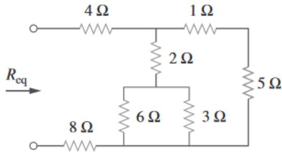
Figura 2.5: Resistencia equivalente del circuito mostrado.
