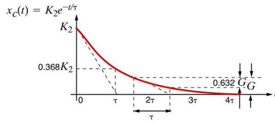
Figura 6.10: Decaimiento de la señal en función de la constante de tiempo.
