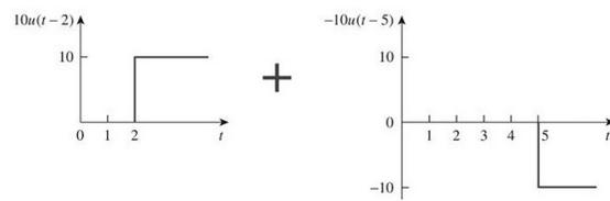
Figura 6.21: Función compuerta como suma de dos funciones escalón.
