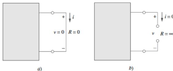
Figura 2.1: a) corto circuito, b) circuito abierto.
