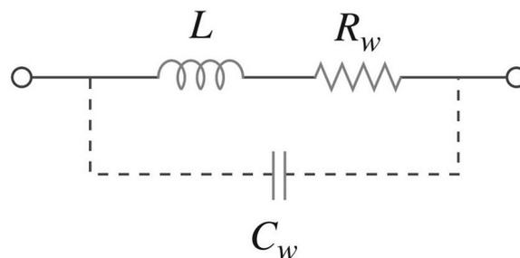
Figura 5.7: Circuito del modelo para un inductor práctico.
