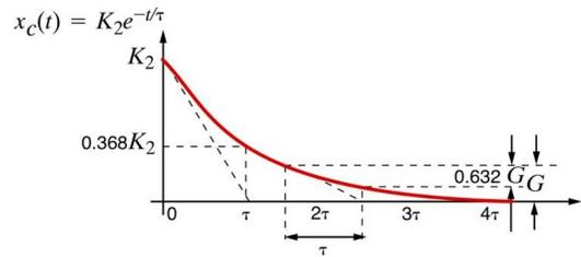
Figura 6.1: Decaimiento de la señal en función de la constante de tiempo.
