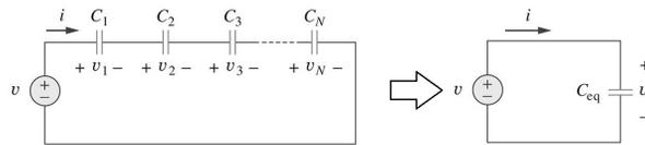
Figura 5.4: Circuito equivalente de capacitores en serie.
