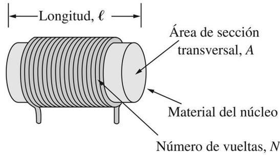
Figura 5.5: Un inductor consiste de un embobinado de alambre conductor.
