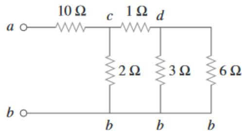
Figura 2.9: Resistencia equivalente del circuito mostrado.
