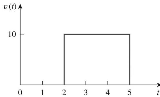
Figura 6.20: Función compuerta.
