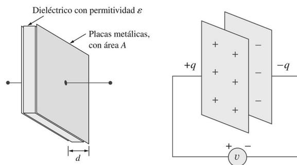
Figura 5.1: Un capacitor consiste de dos placas conductoras separadas por un aislante (o dieléctrico).
