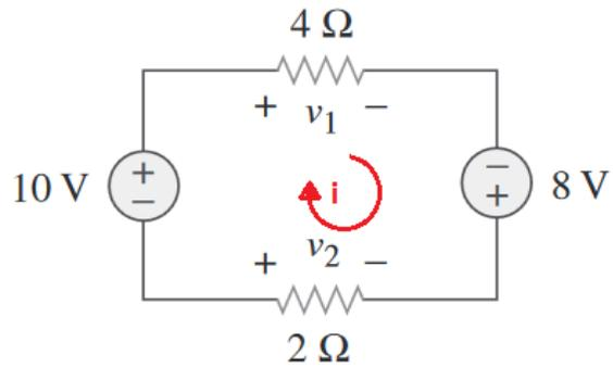
Figura 2.2: Utilización de la ley de voltaje de kirchhoff para resolver el circuito.
