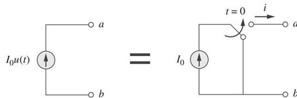
Figura 6.19: Función escalón con fuente de corriente.
