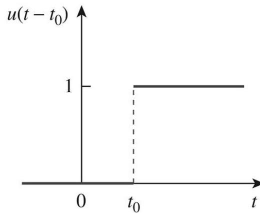
Figura 6.16: Función escalón desplazada  $t_0$ .
