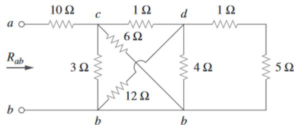
Figura 2.8: Resistencia equivalente del circuito mostrado.
