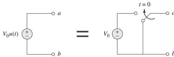
Figura 6.18: Función escalón con fuente de voltaje.
