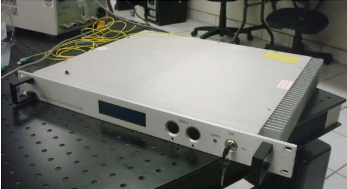
Figura 11: EDFA, vista completa
