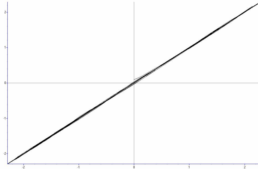
Fig. 4.5.1 Señal de sincronización entre los dos circuitos de Chua x_1(t) vs x_{r1}(t)
