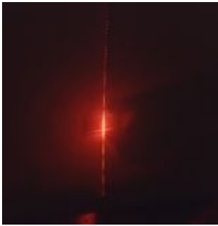
Fig. 1,2,3. Patrón de difracción obtenido de un difusor, en forma lineal
